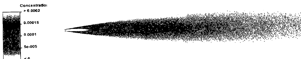
Figure 4 - Champ de concentration dans un jet rond (diamètre de l'orifice d_o = 2 cm, vitesse initiale u_o = 50 m/s, concentration initiale de contaminant c_o = 0,001 kg / kg d'air)
